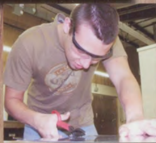
Z a c h F o u l k ( L e f t ) U s e s t h e t i n s n i p s t o c u t p a r t s o u t o f a s h e e t o f a l u m i n u m .
